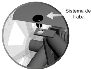
**PASO 2:** Utilizar las **Grampas Plásticas** del **Kit de Ensamblaje** para trabar los laterales del **Cubremotor**.
